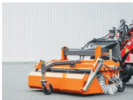
bema 20 (hydrauliczne opróżnianie)
