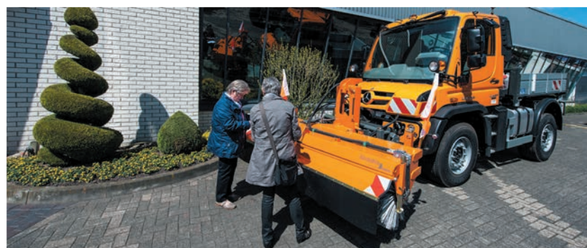
bema 3 Robust - zamontowana na pojeździe Unimog z hydraulicznym przesuwem bocznym
