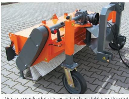
Wersja z przekładnią i jeszcze bardziej stabilnymi kołami jezdными Ø 360 x 85 mm (specjalna konstrukcja)
