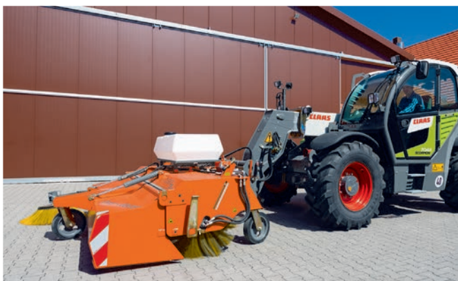
bema 75 Dual PowerMaster na ładowarce teleskopowej z systemem szybkiego montażu
