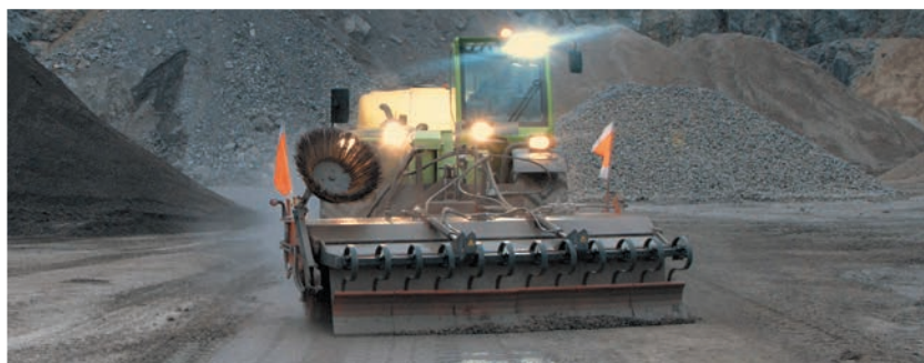
bema 75 Dual PowerMaster ze zgarniaczem zamiast kosza zbierającego, szczotką boczną, wysokociśnieniowym systemem spłukiwania i zbiornikiem na wodę z tył
