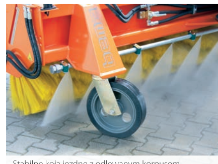
Stabilne koła jezdne z odlewającym korpusem, wysokociśnieniowy system splukiwania
