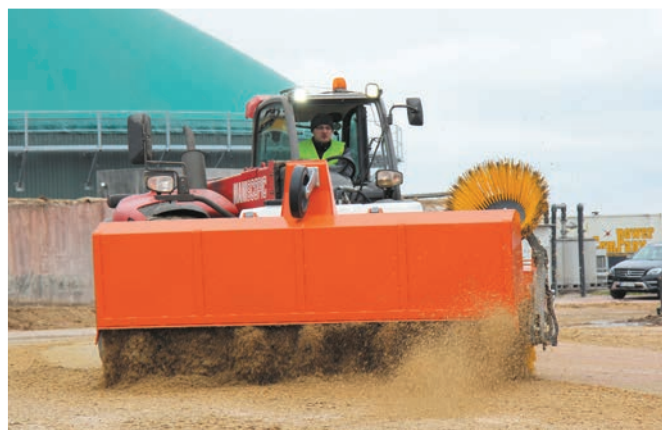
Swobodne zmiatanie biogazowni za pomocą bema 75 Dual PowerMaster
