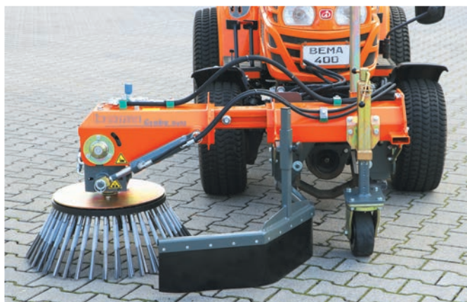
Elastyczna dzięki teleskopowemu przesuwowi bocznemu (300 mm)
