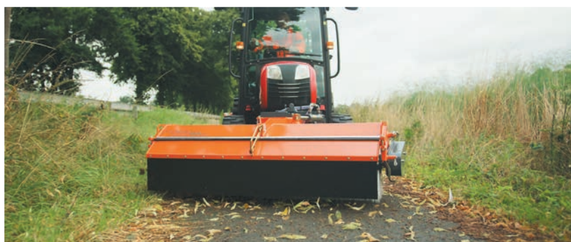
Swobodne zmiatanie z bema Kommunal 450 Dual z fartuchem gumowym (bez kosza zbierającego)
