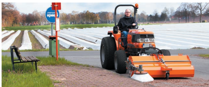
bema Kommunal 580 Dual ze szczotką boczną - optymalna do krawężników, rynsztoków i przy budynkach
