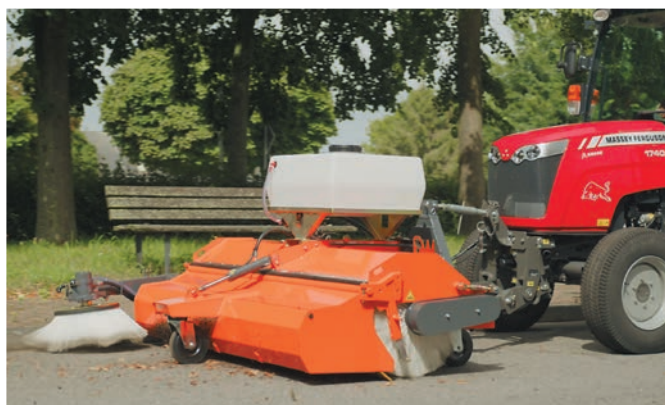
bema Kommunal 580 Dual ze spryskiwaczem wody dla głównej szczotki zmiataarki i szczotką boczną, zbiornikiem wody na maszynie
