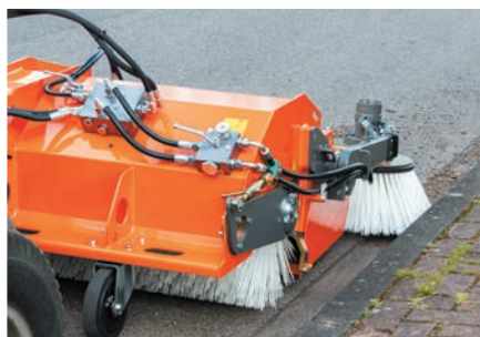
Hydroblok i szczotka boczna z systemem bema SideControl
