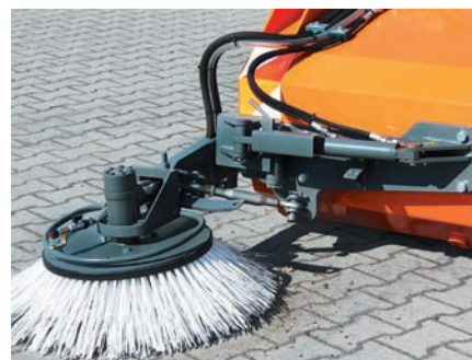
Stabilne mocowanie szczotek bocznych
