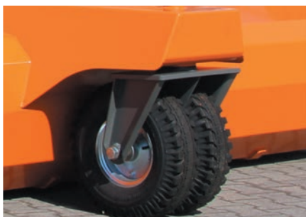
Stabilne koła bliźniacze ze wzmocnionymi obręczami (superelastyczne koła z pełnej gumy Ø 446 x 122 mm)
