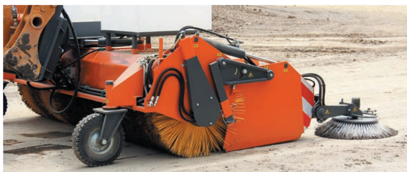
bema Titan Dual na ładowarce kołowej ze szczotką boczną i spryskiwaczem
