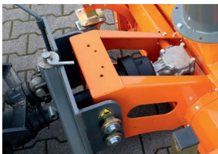
Napęd dyszy ssąco-zamiatającej bema przez przedni wał odbioru napędu (dostępny opcjonalnie)
