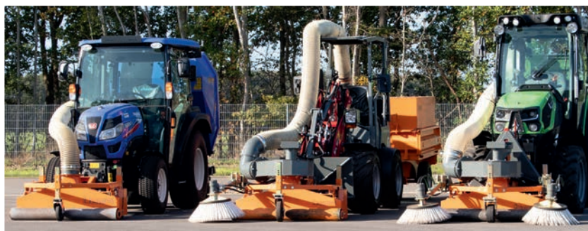
Dysza ssąco-zamiatająca bema zamontowana z przodu bez / z dmuchawą rozdrabniającą w połączeniu z istniejącym kontenerem ssącym lub przyczepą zbiorczą z tyłu (systemy innych firm)
